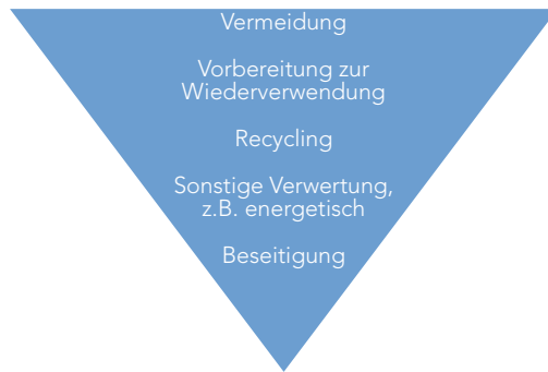
Abb.: Schematische Darstellung der europäischen Abfallhierarchie
